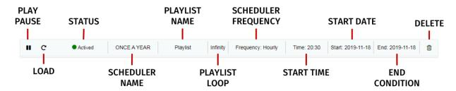
作成されたスケジューラーリストでは、各スケジューラーに設定されているパラメーターが一目でわかるようになっています。
